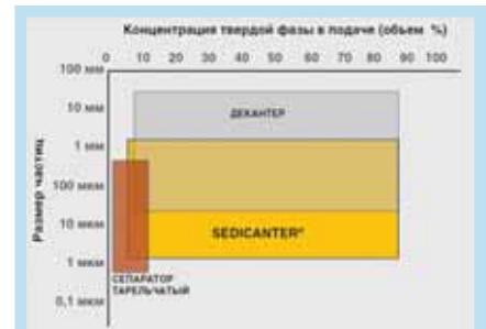
Зависимость концентрации твердой фазы на входе от размерности частиц твердой фазы в разрезе: декантер, седикантер, тарельчатый сепаратор
